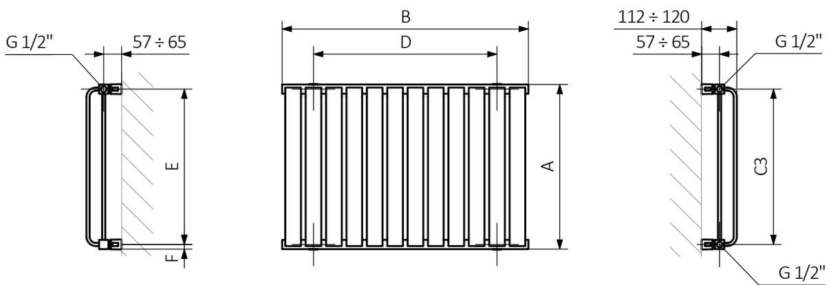
A - Höhe B - Breite C1-C4 - Anschlussabstand D - horizontaler Wandhalterungsabstand E - Vertikaler Wandhalterungsabstand F - Abstand von der Achse der unteren Wandhalterung bis Unterkante des Kollektors
