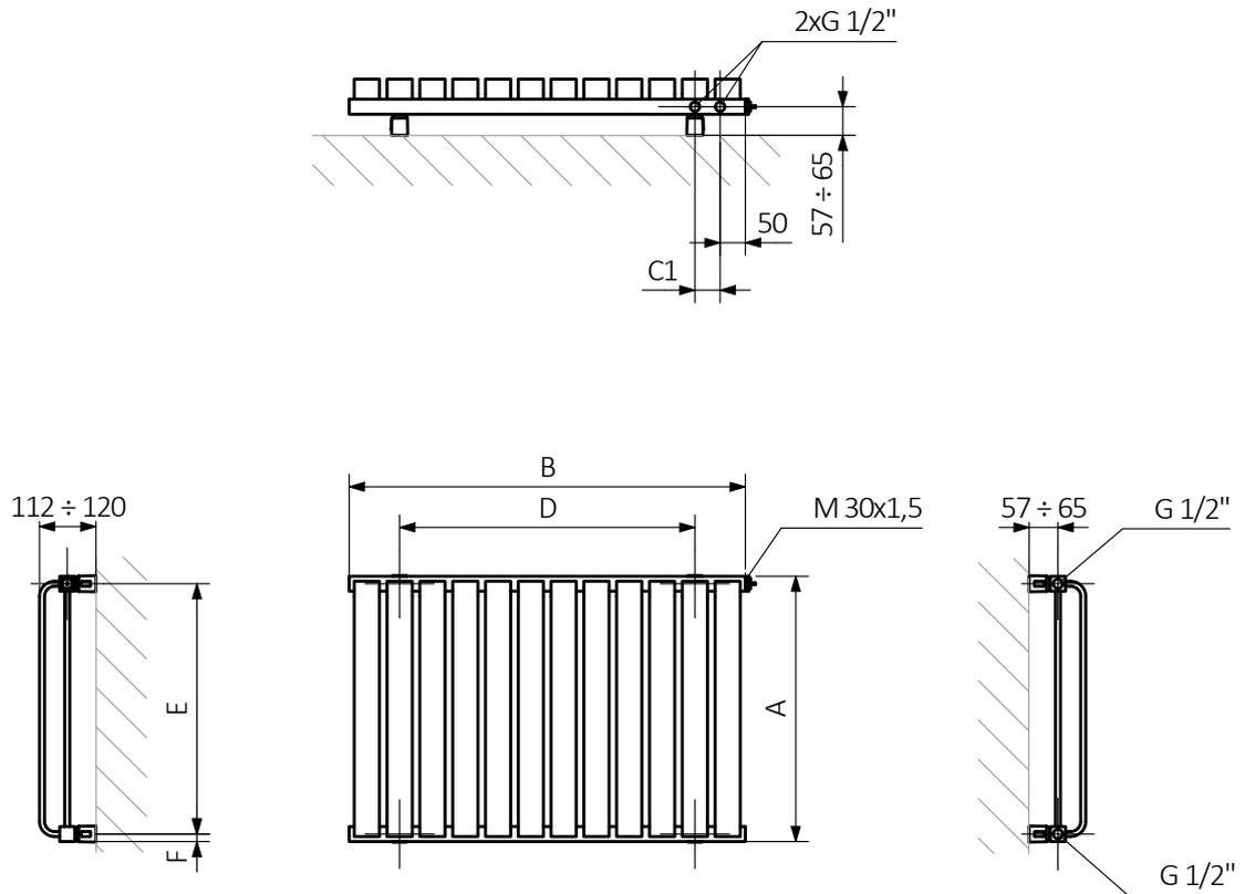
A - Höhe B - Breite C1-C4 - Anschlussabstand D - horizontaler Wandhalterungsabstand E - Vertikaler Wandhalterungsabstand F - Abstand von der Achse der unteren Wandhalterung bis Unterkante des Kollektors
