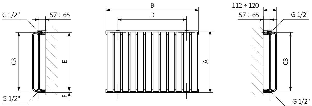
A - Höhe B - Breite C1-C4 - Anschlussabstand D - horizontaler Wandhalterungsabstand E - Vertikaler Wandhalterungsabstand F - Abstand von der Achse der unteren Wandhalterung bis Unterkante des Kollektors
