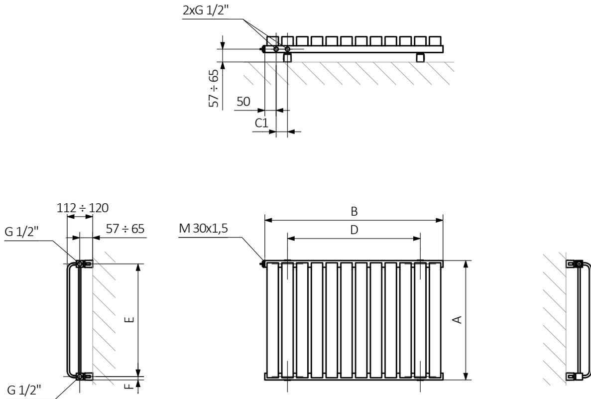
A – Höhe B – Breite C1-C4 – Anschlussabstand D – horizontaler Wandhalterungsabstand E – Vertikaler Wandhalterungsabstand F – Abstand von der Achse der unteren Wandhalterung bis Unterkante des Kollektors
