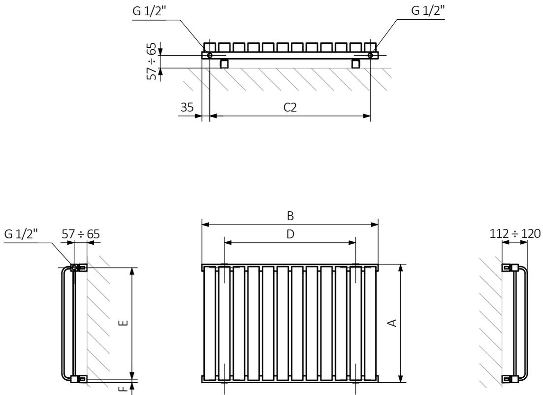
A - Höhe B - Breite C1-C4 - Anschlussabstand D - horizontaler Wandhalterungsabstand E - Vertikaler Wandhalterungsabstand F - Abstand von der Achse der unteren Wandhalterung bis Unterkante des Kollektors
