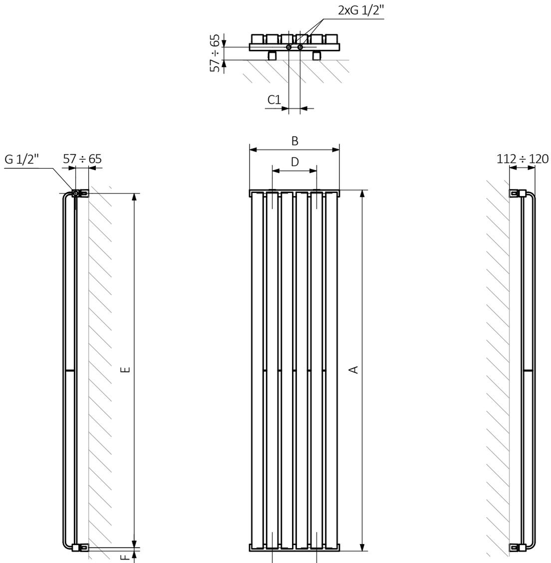
A - Höhe B - Breite C1-C4 - Anschlussabstand D - horizontaler Wandhalterungsabstand E - Vertikaler Wandhalterungsabstand F - Abstand von der Achse der unteren Wandhalterung bis Unterkante des Kollektors
