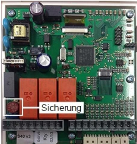
Hat der Regler trotz eingeschalteter Netzspannung keine Funktion und Anzeige, ist evtl. die interne Gerätesicherung defekt. Dann das Gerät wie unter C beschrieben öffnen, alte Sicherung entfernen und überprüfen.
